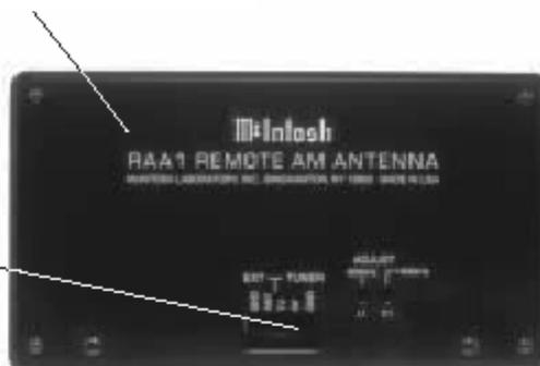
Антенный разъем AM ANT предназначен для подключения дистанционной антенны
