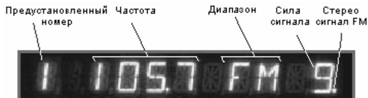
1. Выберите радиовещательный диапазон, используя регулятор INPUT на передней панели или кнопки AM/FM на пульте ДУ.
