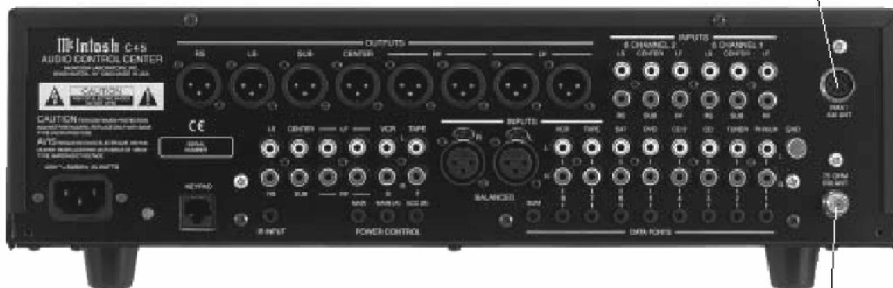
Антенный разъем 75 ом используется для подключения внешней антенны FM или кабеля
